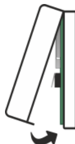
Рисунок 4.19 – Закрытие корпуса ретранслятора Livi RTRM
