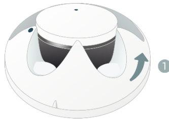
Рисунок 4.4 – Вскрытие корпуса датчика дыма
