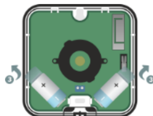
Рисунок 4.23 – Снятие защитных пленок с батареей сирены
