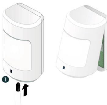
Рисунок 4.1 – Вскрытие корпуса датчика движения
