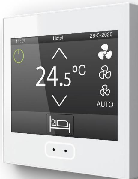
Главная страница настроена для управления внешним термостатом с дополнительными элементами управления. Он показывает полезную информацию, связанную с текущим состоянием других устройств или его собственных элементов управления:
